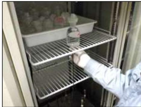
恒温室内で海水の有機物分解実験（50日間）
