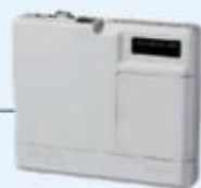
遠隔型監視装置による 計測データのリアルタイム伝送 (B社保有技術)
