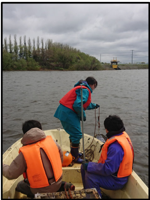
底泥コア試料の採取
